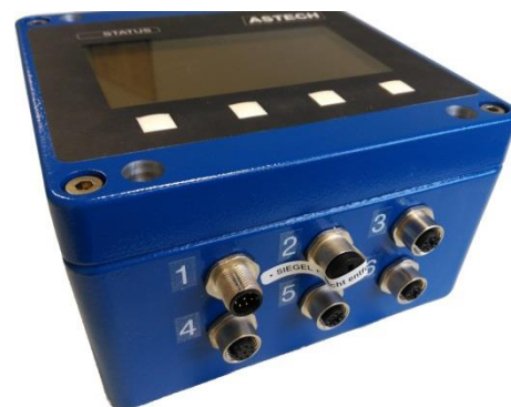
Abbildung 4: CDB mit versiegeltem Programmieranschluss
