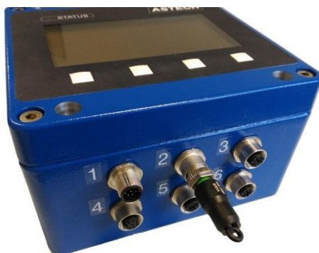
Abbildung 3: CDB mit Programmieradapter
