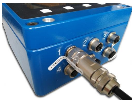
Abbildung 5: Versiegelter Schraubanschluss von CDB
